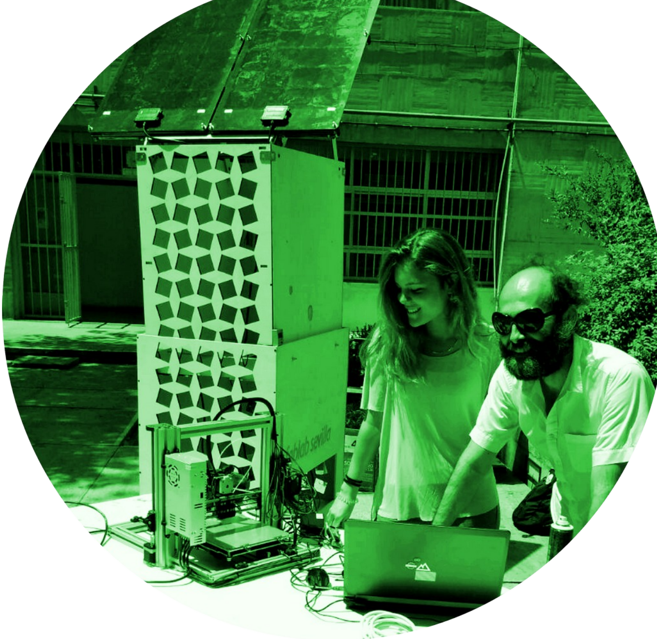
Dispositivo portátil SolarFab, para operación de impresora 3D con energía solar fotovoltaica, J. Pérez de Lama con equipo Fab Lab Sevilla (J.M. Sánchez-Laulhé, Cristina Peñas, Juan Carlos Pérez Juidías, Aureliano Gómez) 2017. El prototipo en la imagen fue presentado en los eventos de divulgación científica y tecnológica el Salón del Estudiante y la Feria de la Ciencia de Sevilla 2017, contando con ayuda del VI Plan Propio de Investigación y Transferencia de la Universidad de Sevilla (Acción III.3).
